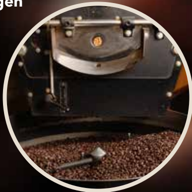
Langzeitröstverfahren im Trommelröster
